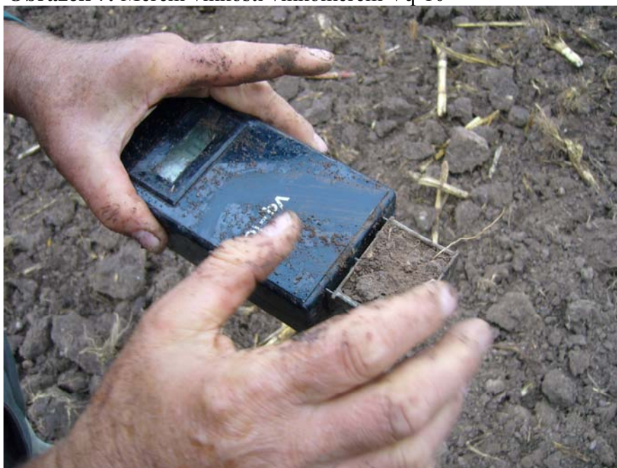
Obrázek 7: Měření vlhkosti vlhkoměrem Vq-10
