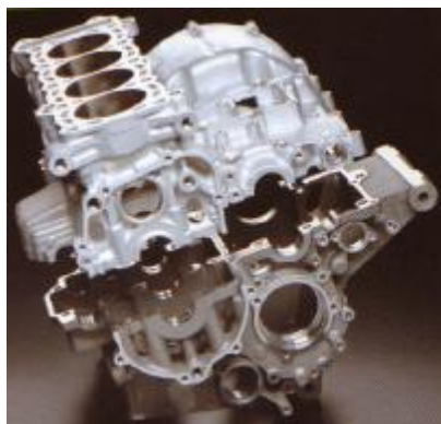
Obr. 3-6 Horizontálně dělená motorová skříň (Suzuki GSX-R600)
