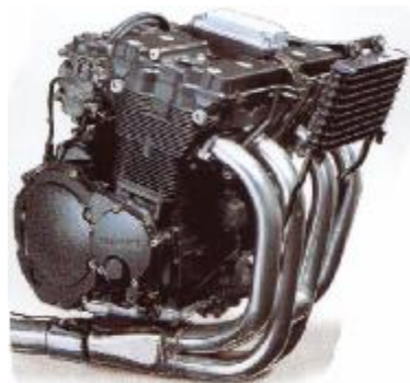
Obr. 3-10 Olejem a vzduchem chlazený motor (Suzuki Bandit 650)
