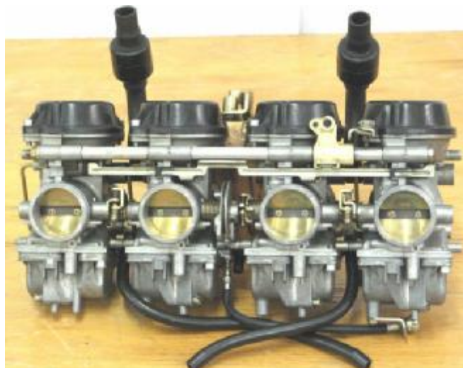
Obr. 3-21 Baterie rovnotlakých karburátorů Mikuni
