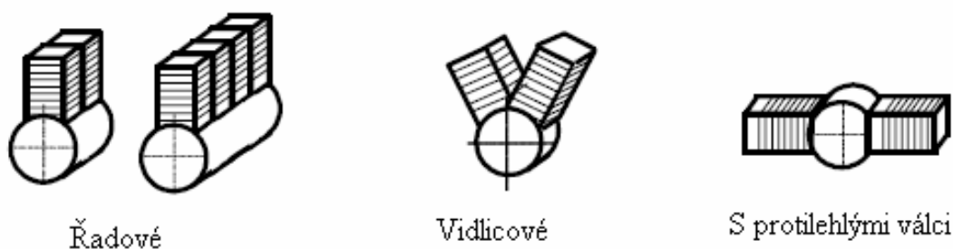
Obr. 3-7 Nejznámější provedení uspořádání válců motoru
