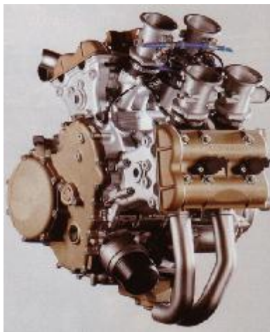
Obr. 3-8 Kapalínou chlazený motor (Ducati Desmosedici RR)
