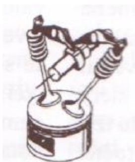
Obr. 3-11 Schéma rozvodu OHC
