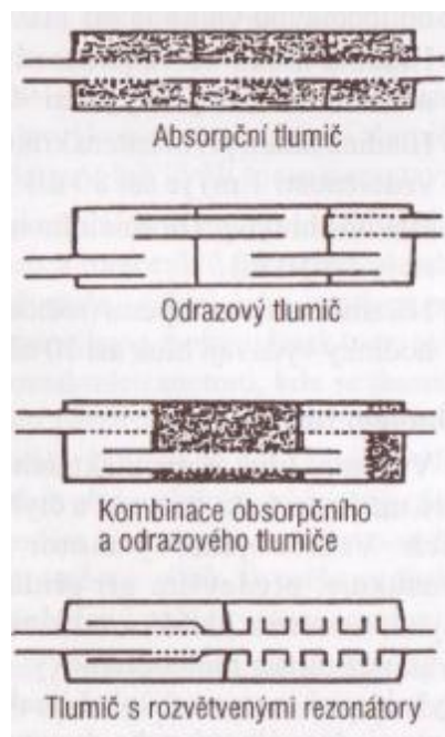
Obr. 3-23 Různé typy konstrukce tlumiče výfuku
