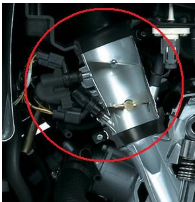
Obr. 3-22 Vstřikovací systém s dvěma vstřikovači a dvěma škrťacími klapkami (Suzuki GSX-R 1000)
