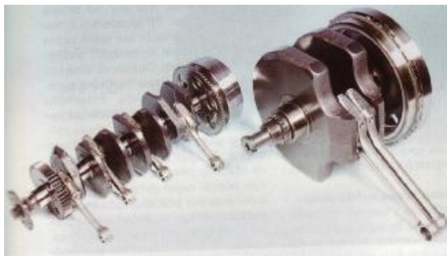
Obr. 3-1 Celistvé klikové hřídele čtyřválcového a dvouválcového motoru
