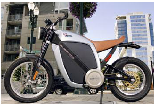
Obr. 5-3 Motocykl Enertia s elektromotorem
