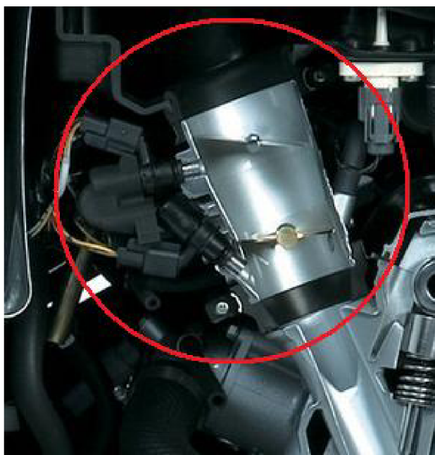
Obr. 3-22 Vstřikovací systém s dvěma vstřikovači a dvěma škrtkovými klapkami (Suzuki GSX-R 1000)
