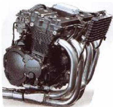
Obr. 3-10 Olejem a vzduchem chlazený motor (Suzuki Bandit 650)
