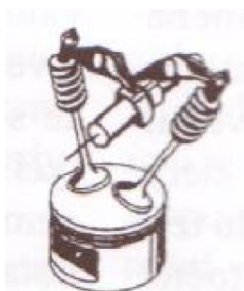
Obr. 3-11 Schéma rozvodu OHC
