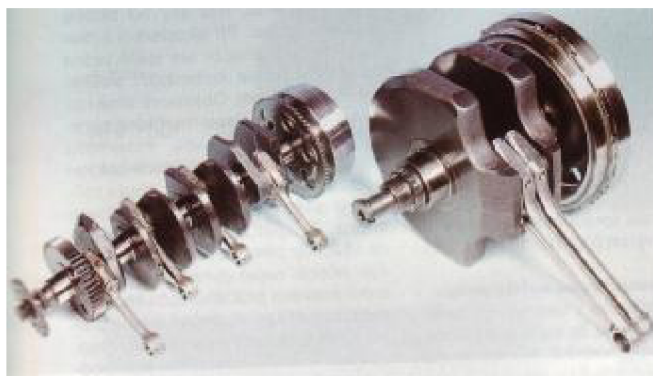
Obr. 3-1 Celistvé klikové hřídele čtyřválcového a dvouválcového motoru
