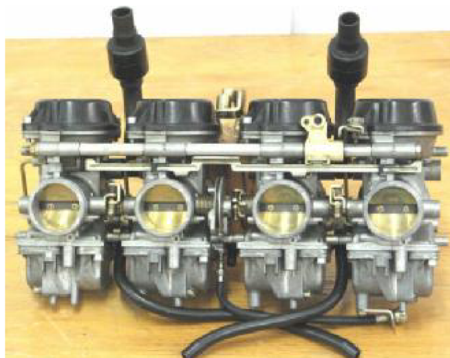
Obr. 3-21 Baterie rovnotlakých karburátorů Mikuni
