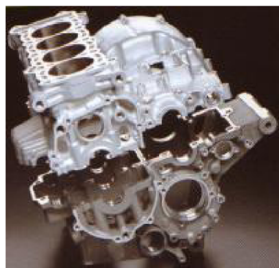
Obr. 3-6 Horizontálně dělená motorová skříň (Suzuki GSX-R600)
