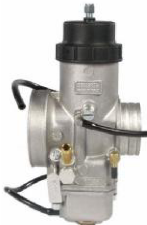
Obr. 3-20 Šoupátkový karburátor DellOrto VHSB 34 LD
