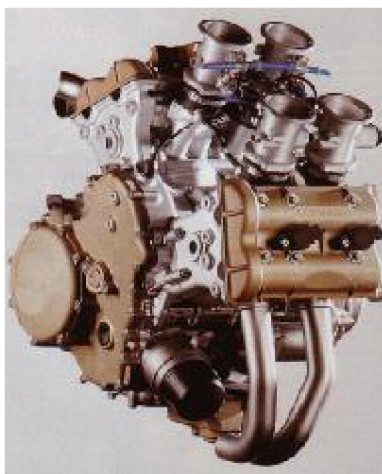
Obr. 3-8 Kapalínou chlazený motor (Ducati Desmosedici RR)
