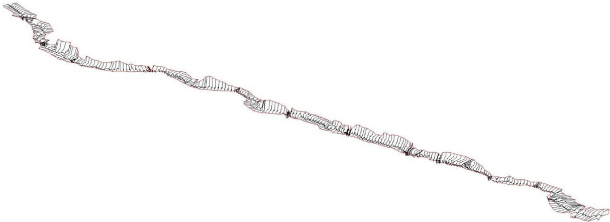
Obr. 4.6 – Schéma použitých profilů v 1D modelu
