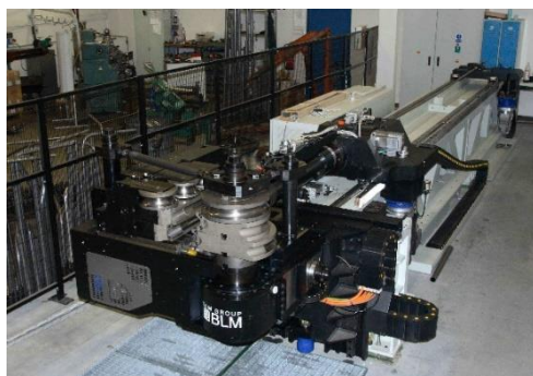
Obr. 60 (vlevo) Ohýbání trubek, BLM ELECCT-80 Obr. 61 (vpravo) Ohraňovací lis, AMANDA HFE 100-3
