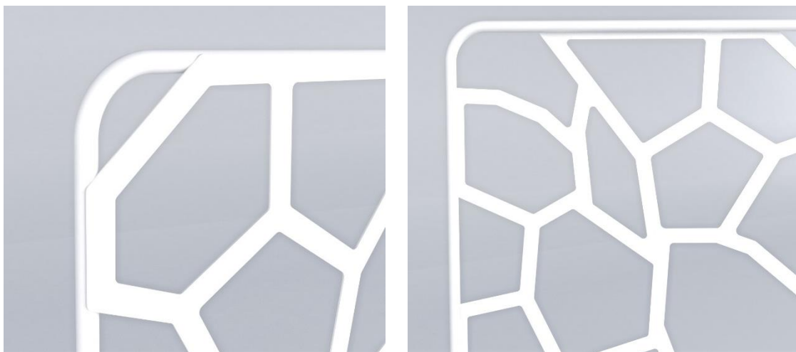
Obr. 53 Umístění plechového dílce na trubkovou konstrukci, pohled z obou stran
