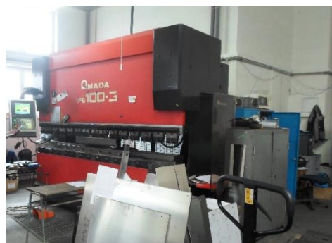
Obr. 60 (vlevo) Ohýbání trubek, BLM ELECCT-80 Obr. 61 (vpravo) Ohraňovací lis, AMANDA HFE 100-3
