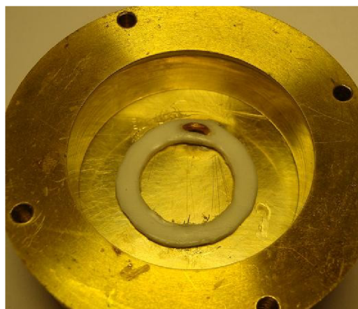
Obr. 35 Budící smyčka s kroužkem B
