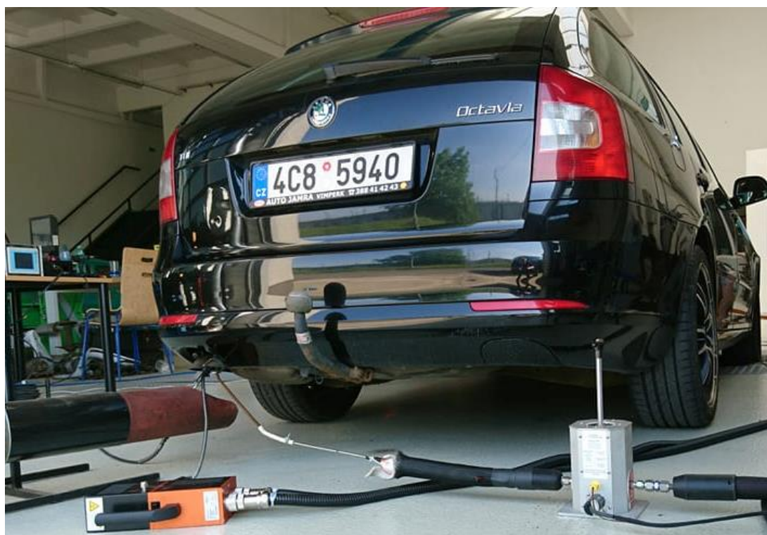
Obr. – 21 Připojení EEPS
