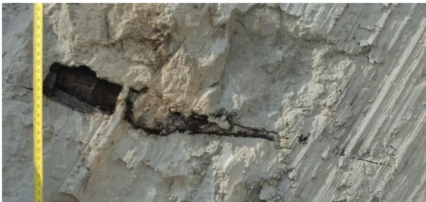
Obrázek 25: Zuhelnatělý kořen v pelokarbonátu.
