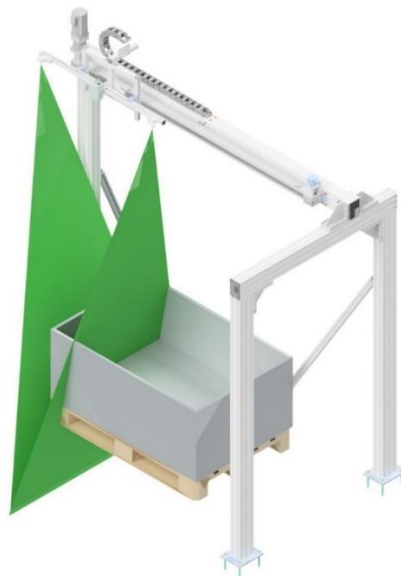
Obr. 38) Sestava bin pickingového portálu
