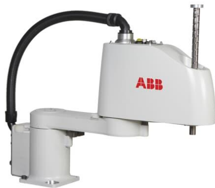
Obr. 2) Robot typu SCARA [5]
