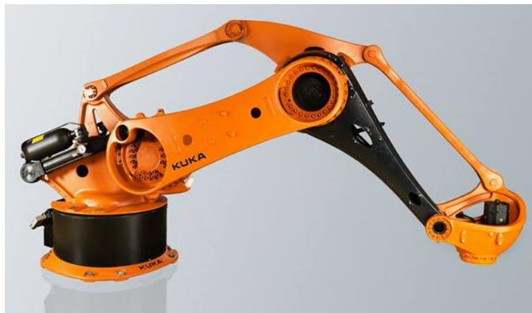
Obr. 8) Paletizační robot KUKA KR 700 PA [18]
