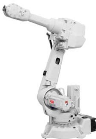
Obr. 4) Šestiosý robot ABB IRB 2600 [9]
