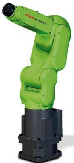
Obr. 9) Kolaborativní robot FANUC CR-4iA [20]
