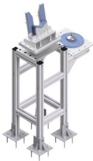
Obr. 41) Stanice pro vystředění a otočení součásti
