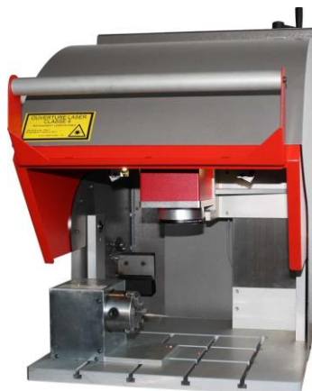
Obr. 20) Pracovní stanice L-Box V4 pro laserové popisování [46]
