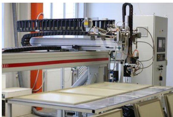
Obr. 1) Příklad karteziánského robotu [3]
