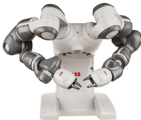
Obr. 3) Dvouramenný kolaborativní robot IRB 14000 YuMi [7]
