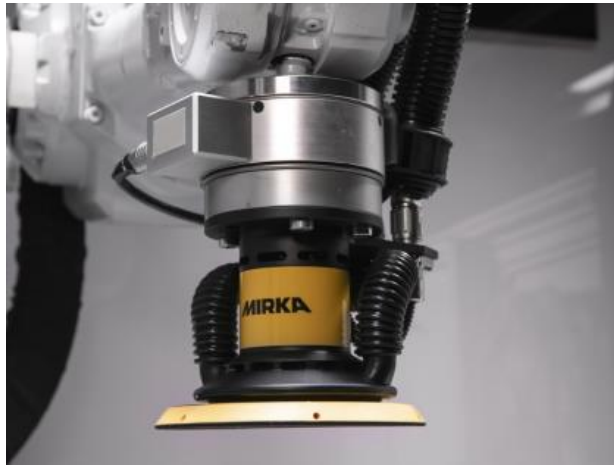
Obr. 10) Technologická výstupní hlavice MIRKA pro broušení [21]
