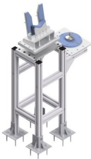
Obr. 41) Stanice pro vystředění a otočení součásti
