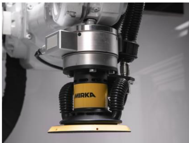
Obr. 10) Technologická výstupní hlavice MIRKA pro broušení [21]
