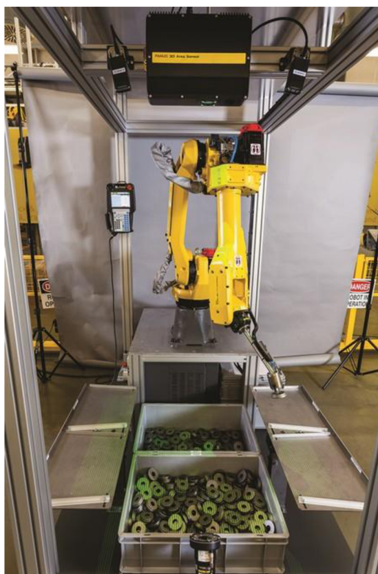
Obr. 18) Řešení Bin Picking firmy FANUC [39]
