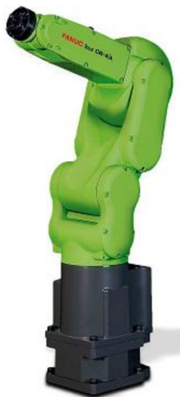
Obr. 9) Kolaborativní robot FANUC CR-4iA [20]
