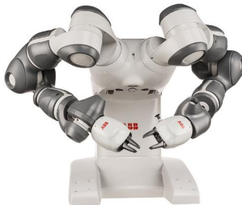
Obr. 3) Dvouramenný kolaborativní robot IRB 14000 YuMi [7]
