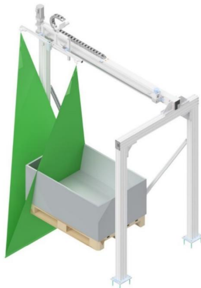
Obr. 38) Sestava bin pickingového portálu
