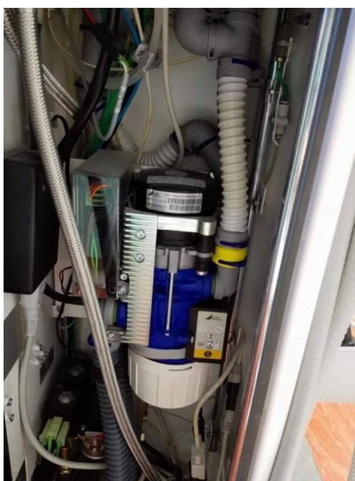
Obr. č. 2.: Separátor amalgámu METASYS (Zdroj vlastní)
