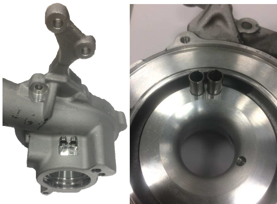
Obr. 34 Kompresorová skříně po úpravě
