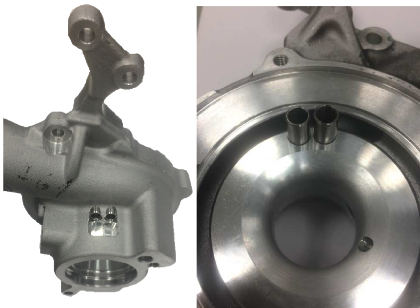
Obr. 34 Kompresorová skříň po úpravě
