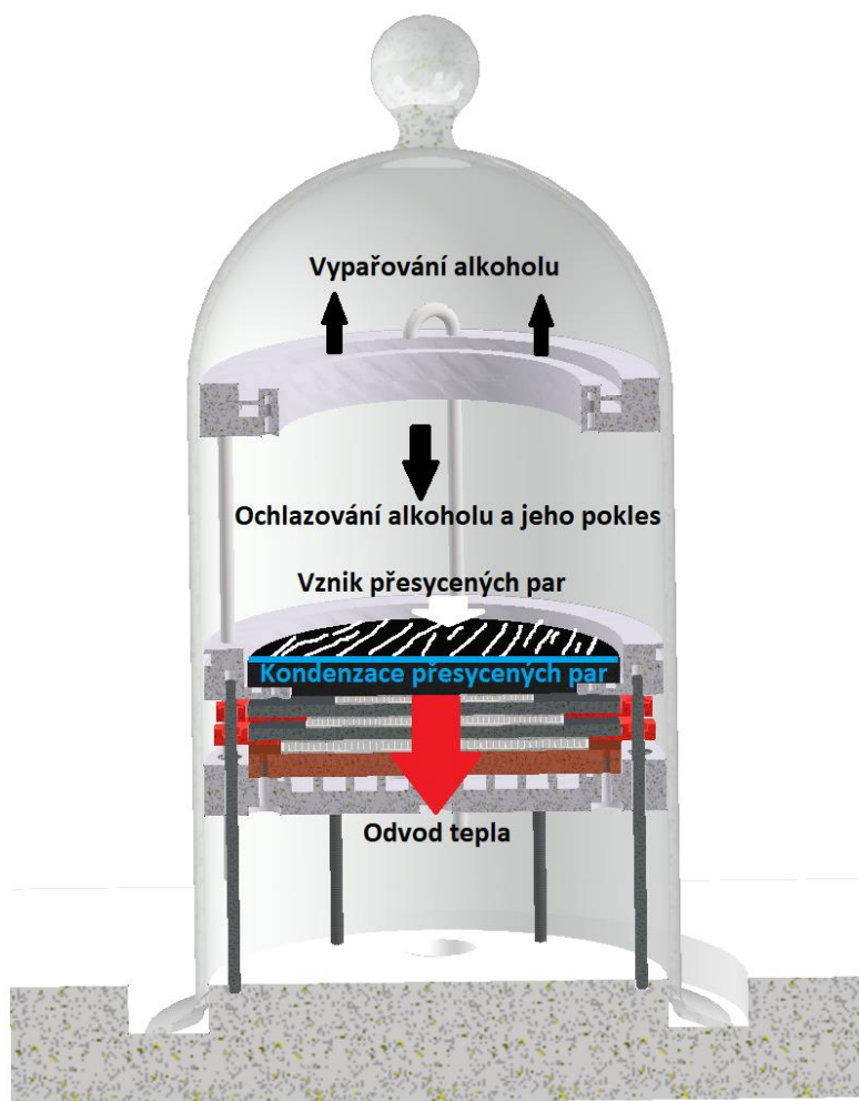
Obr. 3.2: Schéma procesu probíhajícího v mlžné komoře
