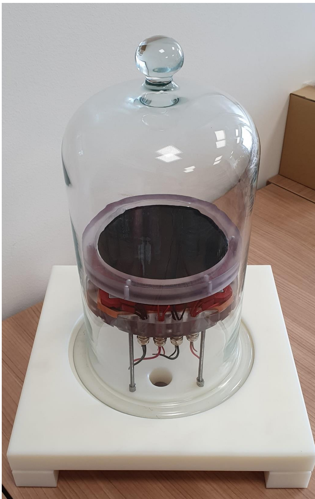
Obr. 3.8 Prvotní realizace mlžné komory
