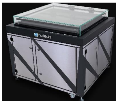
Obr. 2.3: Realizace komerční mlžné komory NULEDO s kompresorovým chlazením [2]
