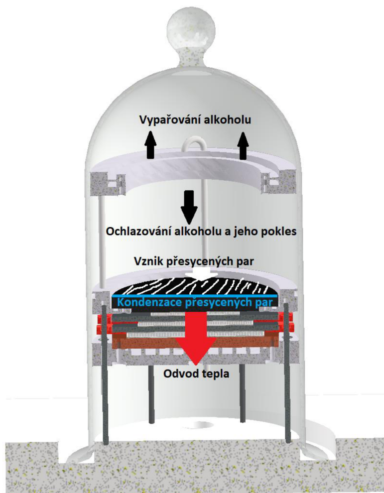
Obr. 3.2: Schéma procesu probíhajícího v mlžné komoře
