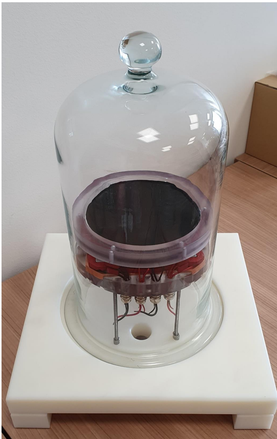
Obr. 3.8 Prvotní realizace mlžné komory
