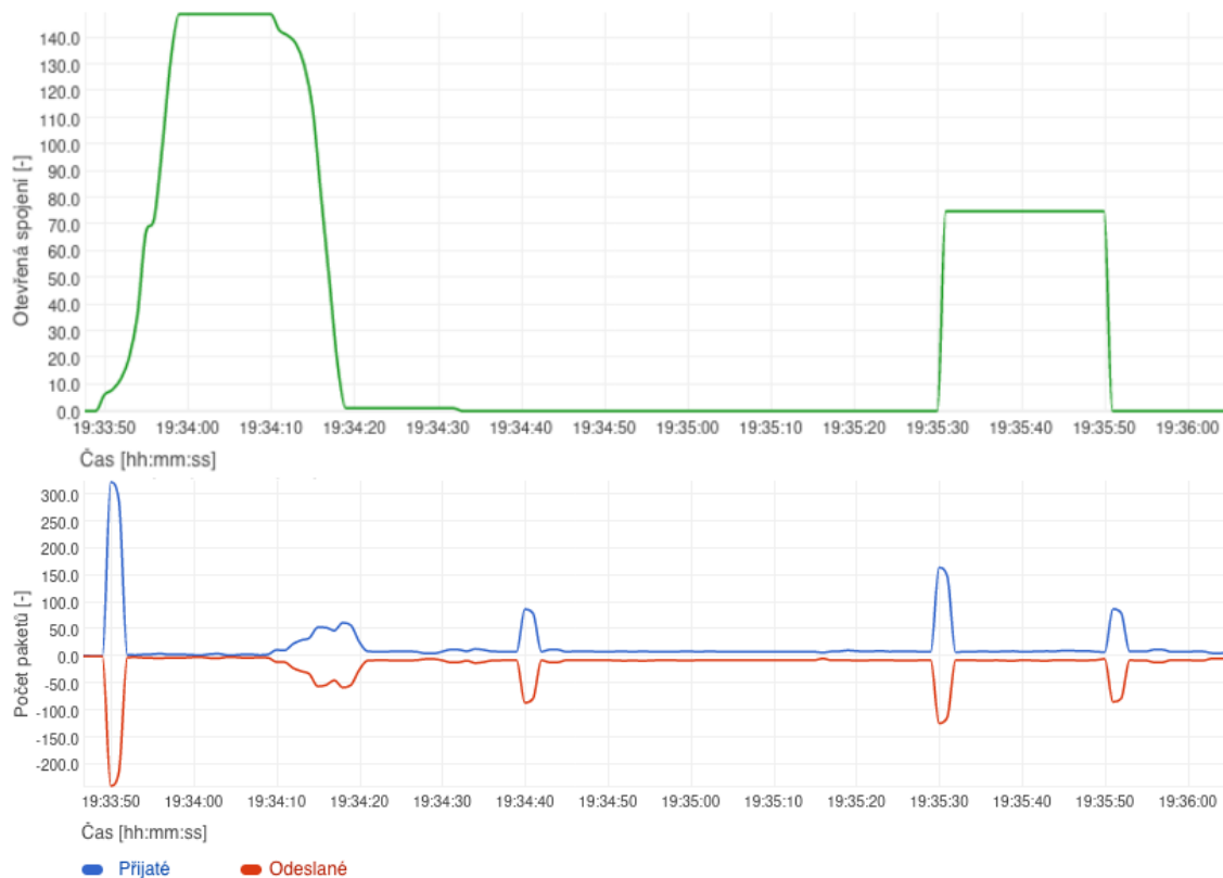
Obr. 3.12: Otevřená spojení s cílovým systémem při útoku Slowloris s výchozí konfigurací Apache.
