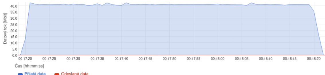
Obr. 3.8: Datový tok cílového systému při útoku Smurf se čtyřmi boty.
