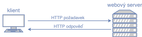
Obr. 1.14: Průběh standardní komunikace protokolu HTTP.
