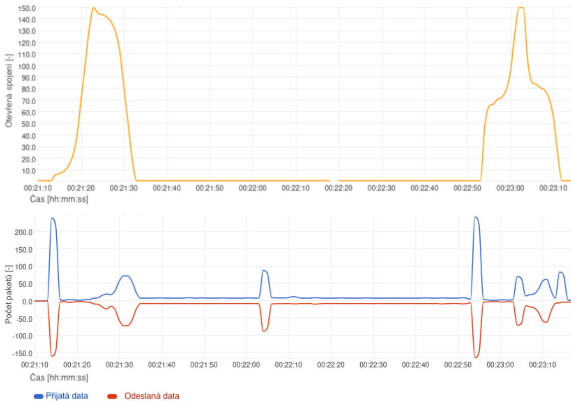
Obr. 3.16: Otevřená spojení s cílovým systémem při útoku RUDY s výchozí konfigurací Apache.
