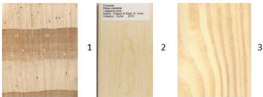
Obrázek 2 Makroskopická stavba dřeva borovice pokroucená, základní řezy dřevem: 1. Příčný řez, 2. Podélný řez, 3. Tangenciální řez (Peterson a Seiler, 2010; David Clark, 2010)
