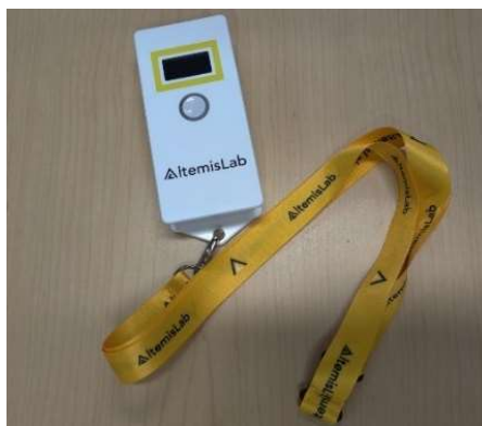
Obrázek 19 AlteRead™ Pendant Single Tube 2D & 1D Barcode Reader For Scanning 2D Barcoded Cryovial Tubes převzato z [21]
