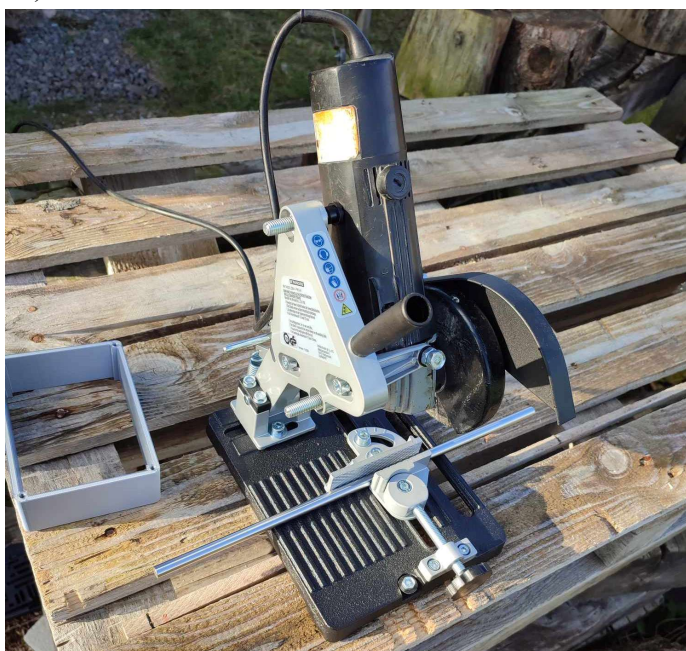
Obrázek 41 Dělení vodící tyče na požadovanou délku
