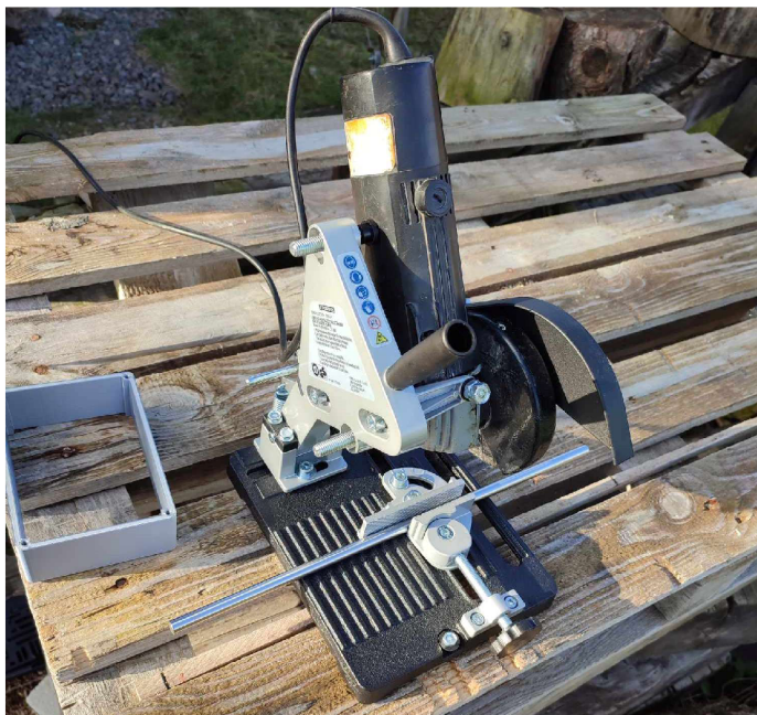
Obrázek 41 Dělení vodící tyče na požadovanou délku
