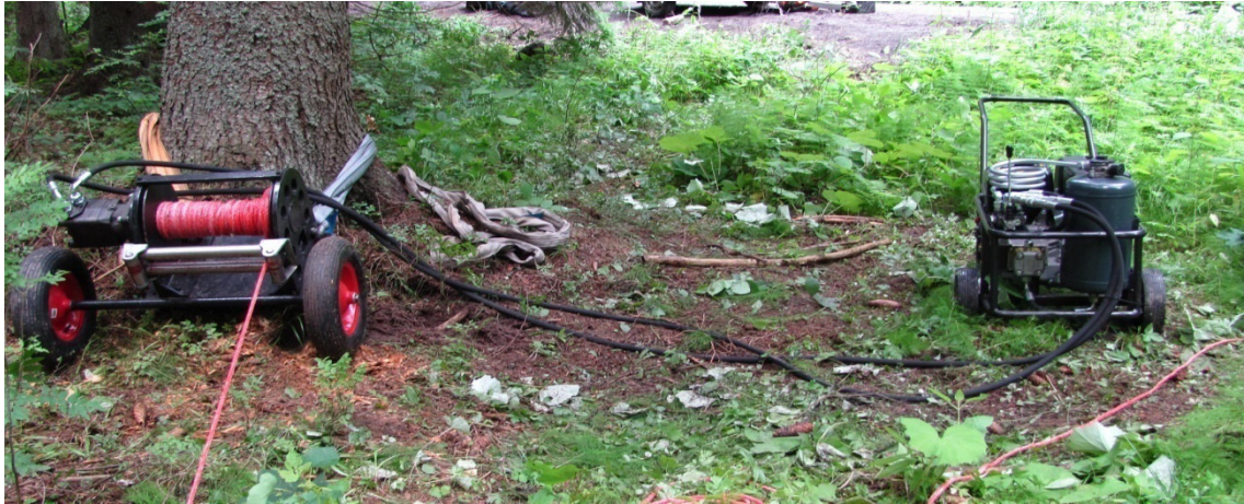
Obrázek č. 9 - Mobilní naviják s pohonnou jednotkou. Zdroj: Eliška Pařízková
