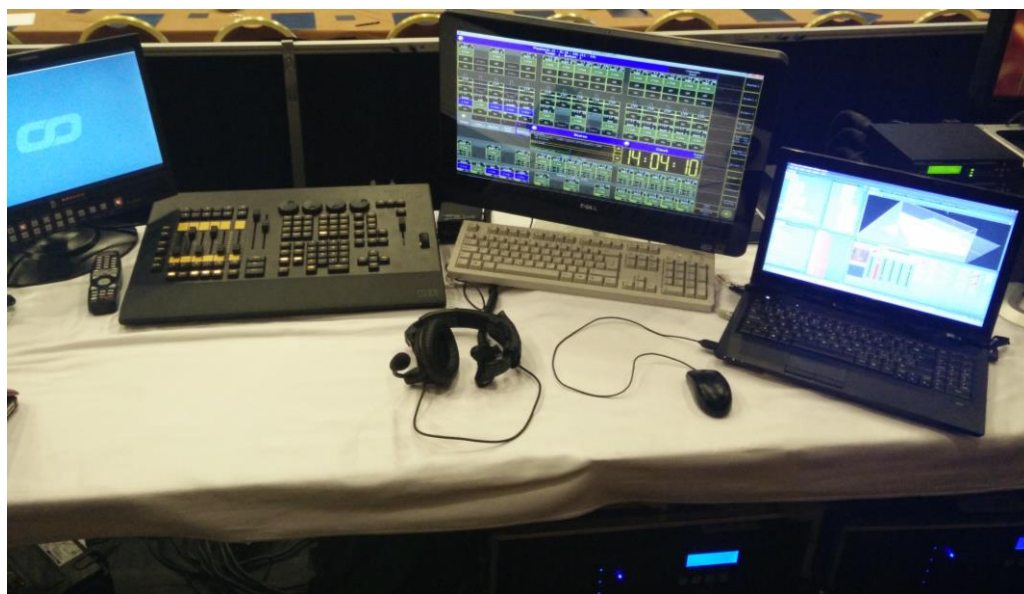
Obrázek 17: Pracoviště k ovládání Coolux a grandMA (Zdroj: autor)
