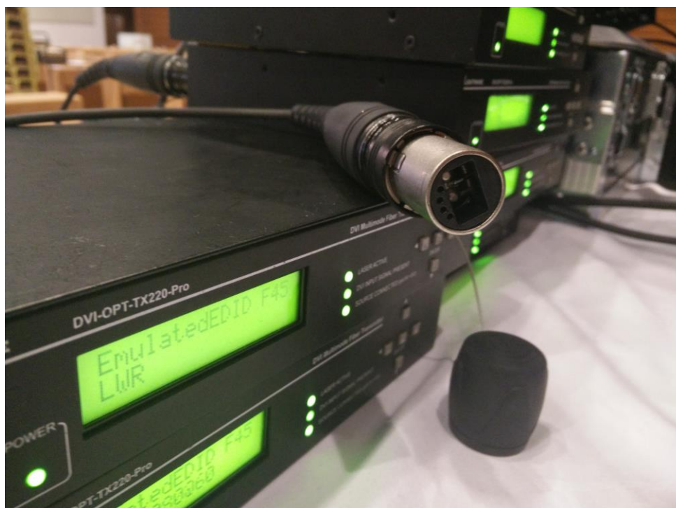
Obrázek 27: Přední strana optického převodníku Lightware DVI-OPT-TX 220 a konektor optického kabelu Neutrik NKO2M-R-2-150 (Zdroj: autor)
