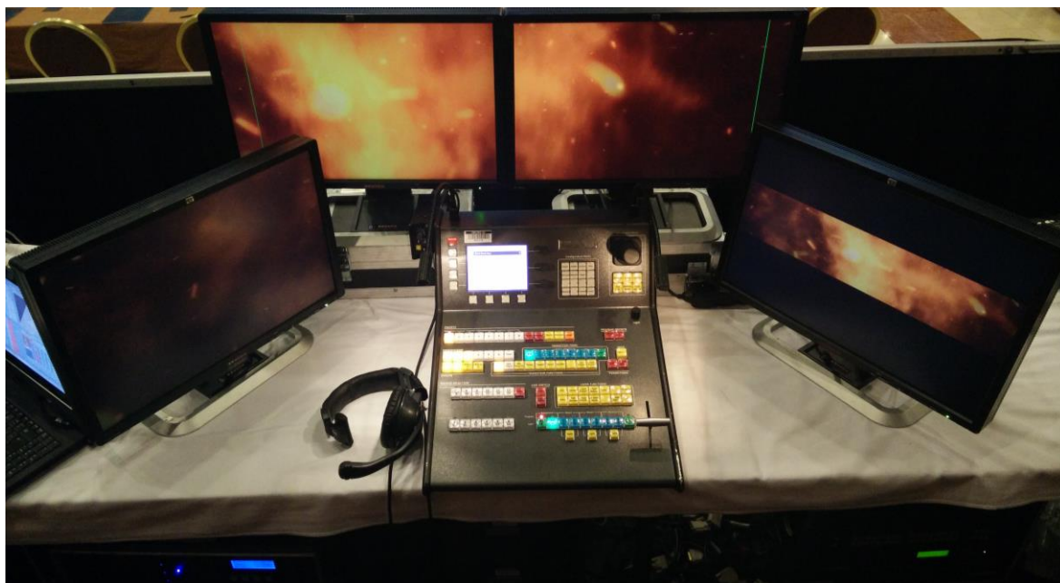
Obrázek 26: Pracoviště Barco Encore Controller SC (Zdroj: autor)
