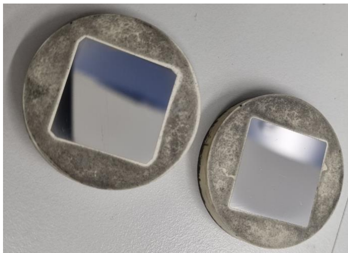
Obrázek 16: připravené vyleštěné vzorky [vlastní zpracování]
