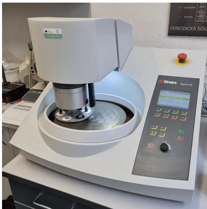
Obrázek 15: laboratorní bruska Struers Tegramin – 30 [vlastní zpracování]
