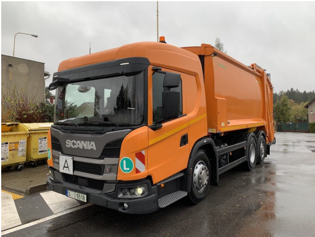
Obr. 3.3 Vozidlo Scania L320 s nástavbou Terberg RosRoca Olympus 20 W s vyklápěčem TCH-D Zdroj: [19]
