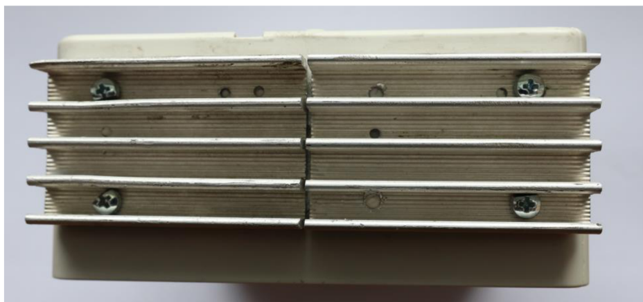
Obrázek 3.9 Pohled na přimontovaný chladič
