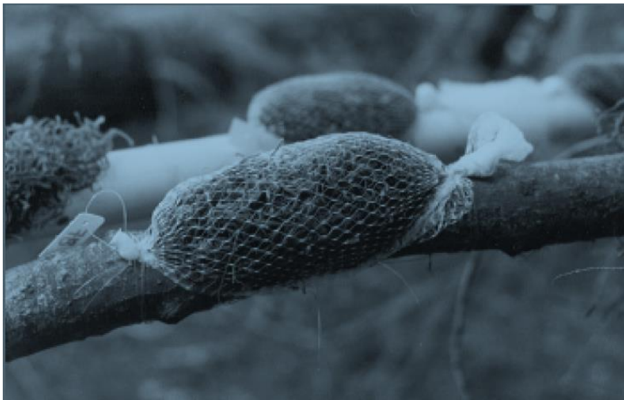
Obr. 36 “Bag“ technika - taška mechu – suché provedení [18]
