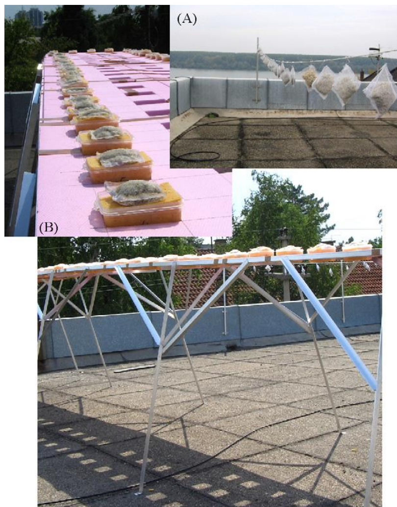
Obr. 39 Experimentální uspořádání "bag" technika (A) suché provedení (B) mokré provedení [79]
