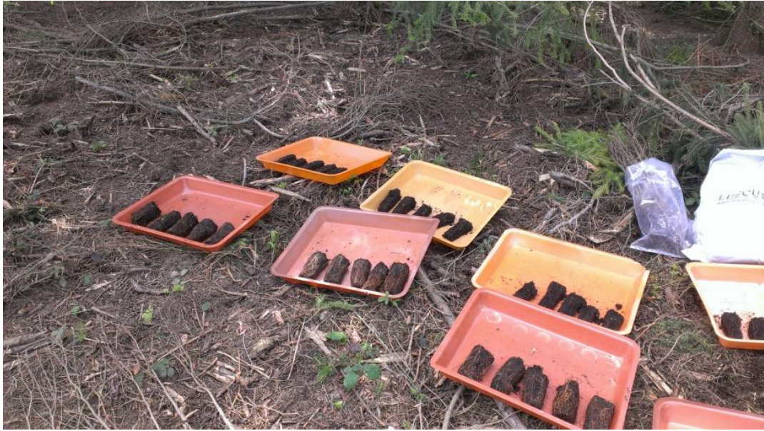
Obr. 5: Testované baly (měření hmotnostního úbytku a vlhkostního úbytku kořenových balů během vysychání) buku lesního (na světlých podložkách) a smrku ztepilého ( na tmavých podložkách) v průběhu vysychání
