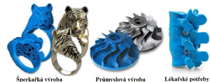
Obrázek 3 Výroba přesných modelů pro odlitky metodou Solidscape
