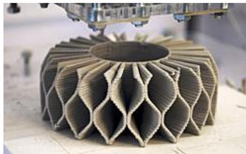
Obrázek 25 Příklad geometricky náročné aplikace 3D tisku keramiky
