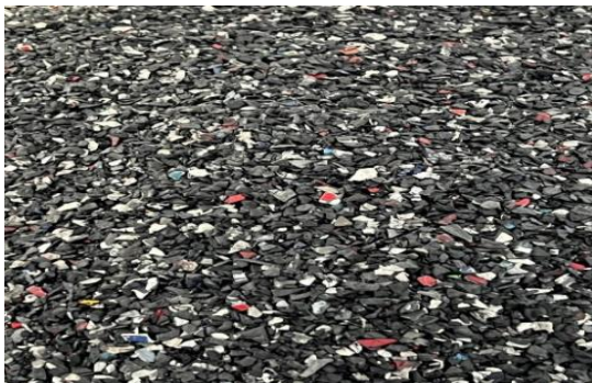
Obrázek 23 - Polypropylen (PP) – nadrcený nárazník
