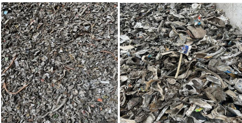
Obrázek 16 Příklad materiálového složení zorby v podobě barevných kovů
