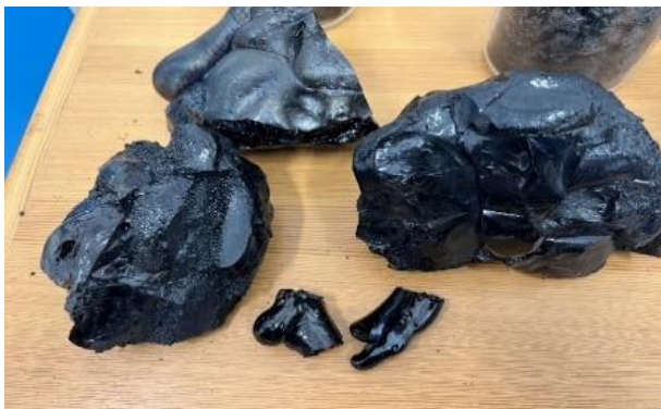
Obrázek 31 - Anorganické nečistoty (struska) z plazmatického zplyňování
