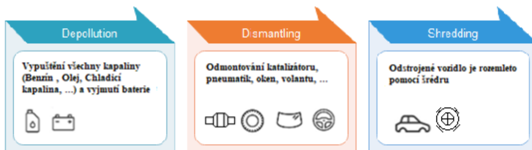
Obrázek 6 - Tři hlavní fáze procesu zpracování vozidel s ukončenou životností
