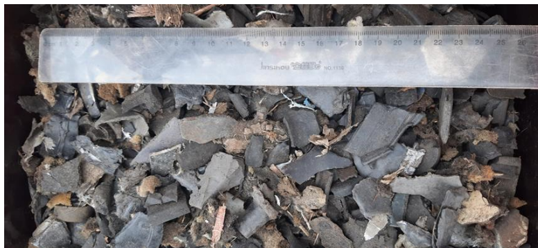
Obrázek 32 - Nadrcené zbytky z automobilového drtiče (ASR)
