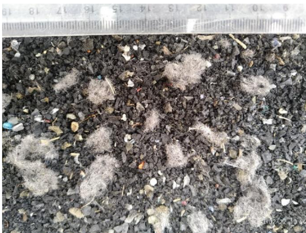
Obrázek 33 - Směs ASR a nadrcených pneumatik v poměru 33 % a 67 %
