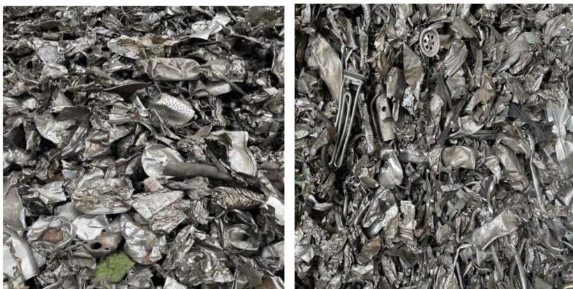
Obrázek 17 - Příklady materiálového složení – nerezová ocel
