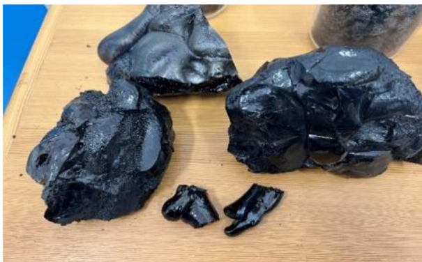
Obrázek 31 - Anorganické nečistoty (struska) z plazmatického zplyňování
