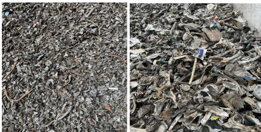
Obrázek 16 Příklad materiálového složení zorby v podobě barevných kovů
