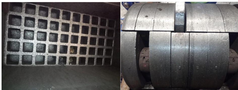
Obrázek 9 - Síto šředru a rotor šředru s nárazovými prvky
