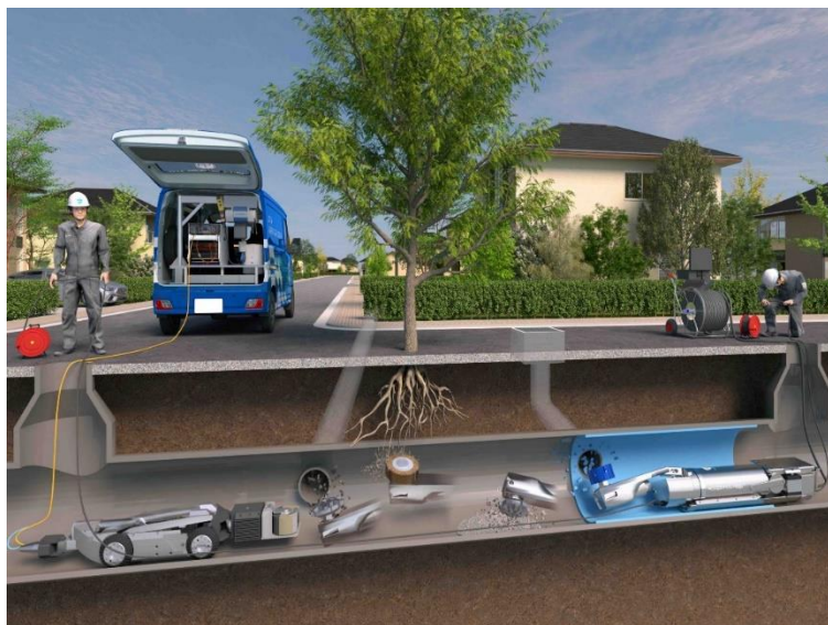
Obr. 2.22 Oprava poruch pomocí kanalizačního robota [28]
