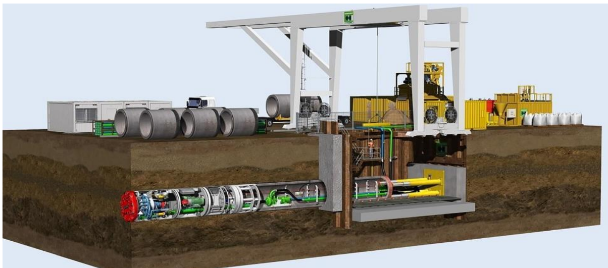
Obr. 2.11 Pracoviště mikrotunelovací soupravy [11]
