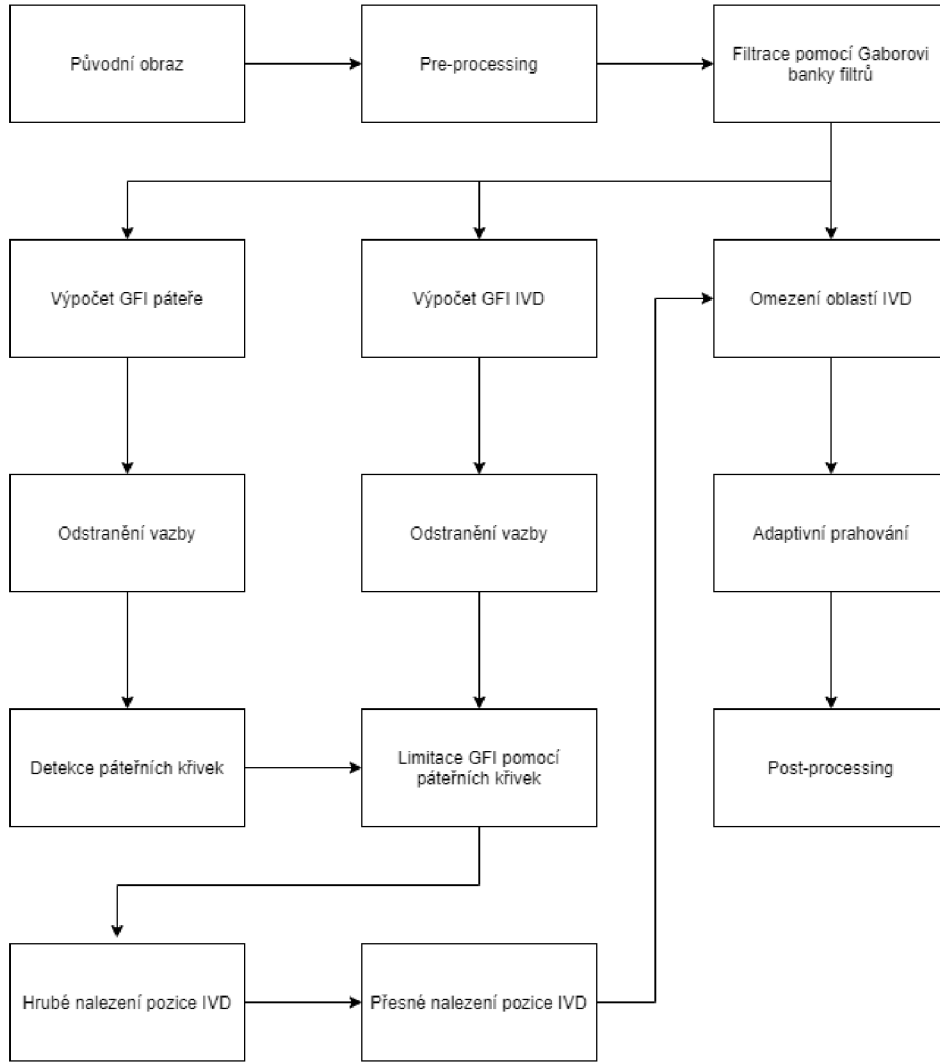
Obr. 3.2: Vývojový diagram segmentační metody využívající banku Gaborových filtrů. [22]
