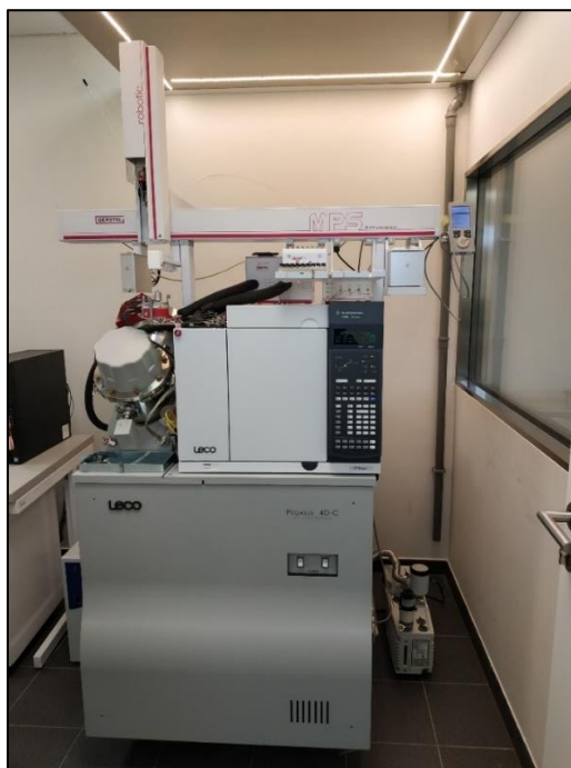
Obrázek 5: Dvourozměrný plynový chromatograf Agilent 7890 B s hmotnostním spektrometrickým detektorem TOF Pegasus 4D (Leco Coporation, USA) s automatickým ramenem pro nástřik vzorků
