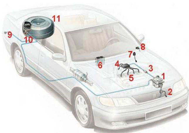
Obr. 4.4 - Zástavba s el. řízeným vícebodovým sekvenčním vstřikováním plynného LPG [2]
