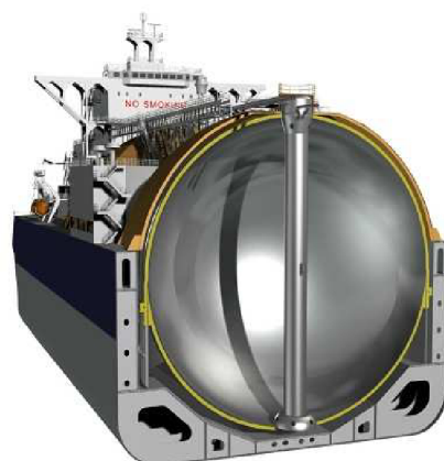
Obr. 5.1 - Řez tankerem pro převoz LNG [31]
