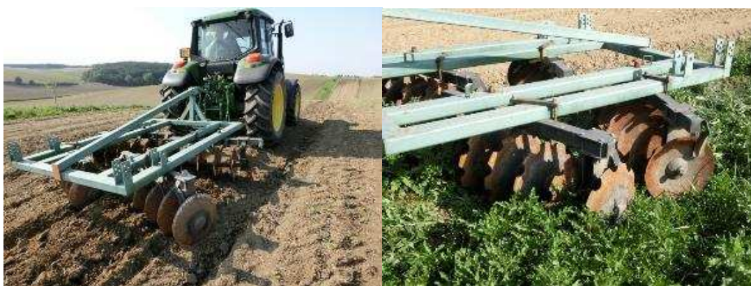
Obr. č. 21: Talířový kypřič 2,5 m (vlevo), talířový kypřič (vpravo) (Hrabalíková a kol., 2015)
