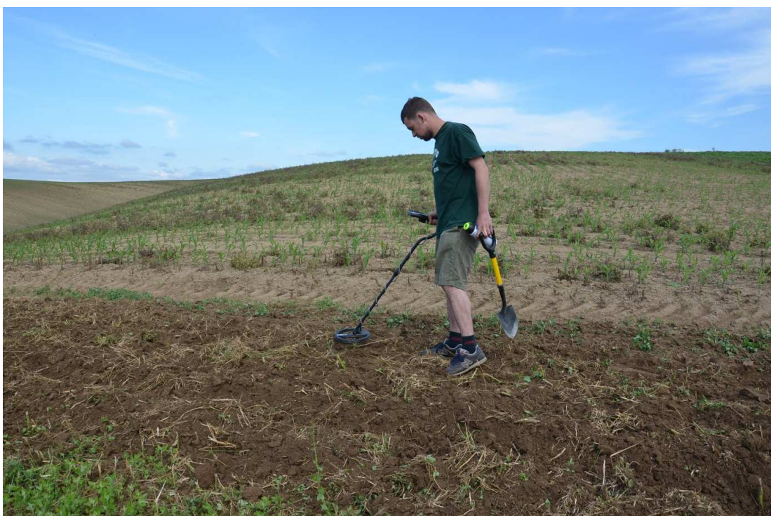
Obr. č. 17: Vyhledávání stopovačů detektorem kovu (Hrabalíková a kol., 2016)
