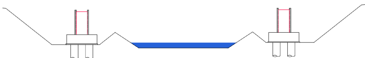
Obrázek 49 - Fáze 2 - Vytvoření bednění pro stojky, armování a betonáž stojek, vytvoření 2. pracovní spáry
