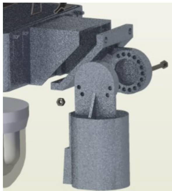
Obr. 4.30: „revolverová“ koncepce příruby – koncept V2X
