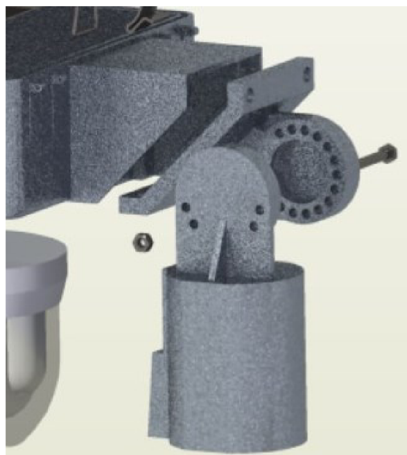
Obr. 4.30: „revolverová“ koncepce příruby – koncept V2X
