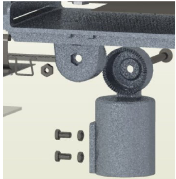
Obr. 4.28: Část příruby integrovaná v odlitku základní desky svítidla – koncept Kompozit
