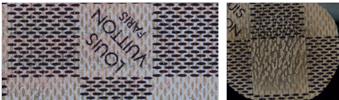
Obrázek č. 52 – Detail originálu (snímek byl pořízen pomocí makroskopu Navitar 12X Zoom s motorizovanou vyhledávačkou) - vlevo před zkouškou, vpravo po 12 000 otáčkách
