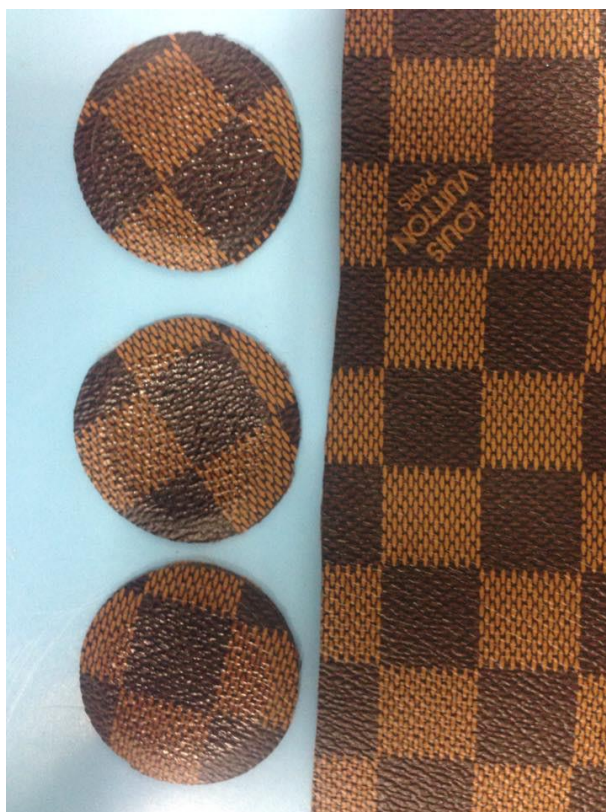
Obrázek č. 53 – Odolnost padělku v oděru - vzorky vlevo po 12 000 otáčkách, vpravo vzorek před oděrem
