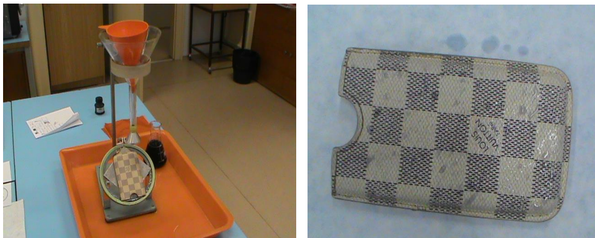
Obrázek č. 49 – Materiál originálu po spray testu
