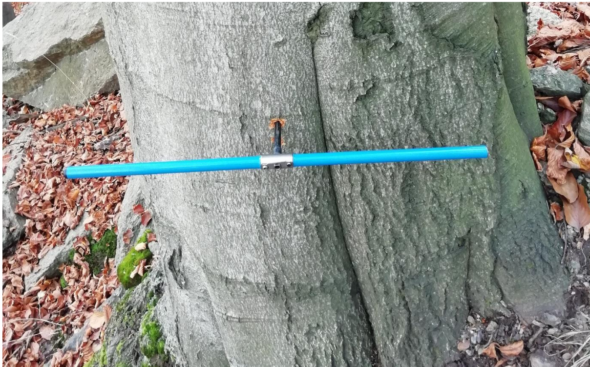
Obrázek 11: Presslerův lesnický nebozez zavrtaný do buku
