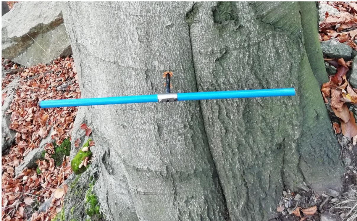
Obrázek 11: Presslerův lesnický nebozez zavrtaný do buku
