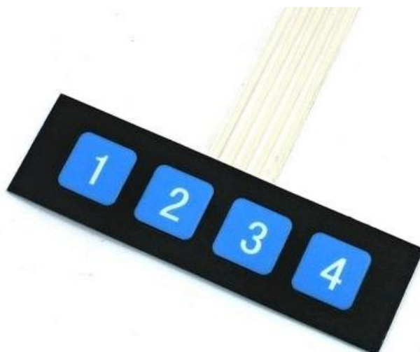
Obr. 4-3 Membránová klávesnice 1x4 (převzato z [24])
