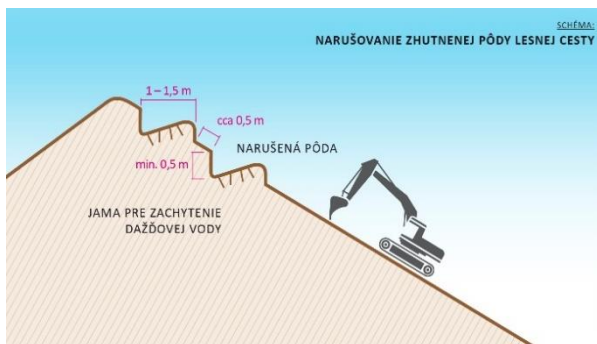
Obrázek 9: Schéma narušování ztuhlé půdy lesní přibližovací linky. Zdroj: Štefan Vaľo 2018; povodne.sk
