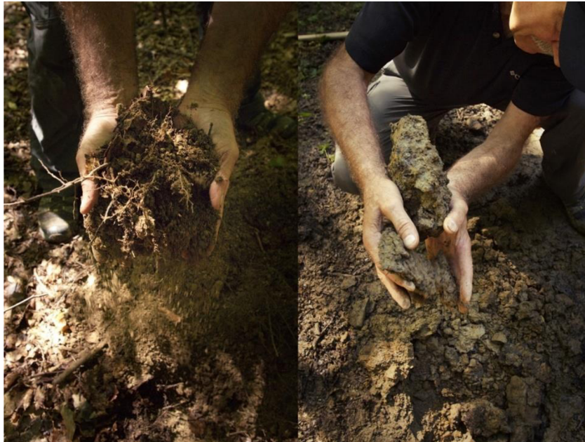
Obrázek 1: Na levé straně neutlačená půda vs. na pravé straně zhutněná půda. Zdroj: Štefan Val'o 2018; povodne.sk
