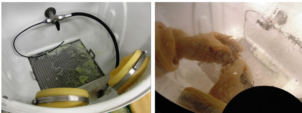
Obr. 5.3 Očištění součástek v mycím zařízení.
