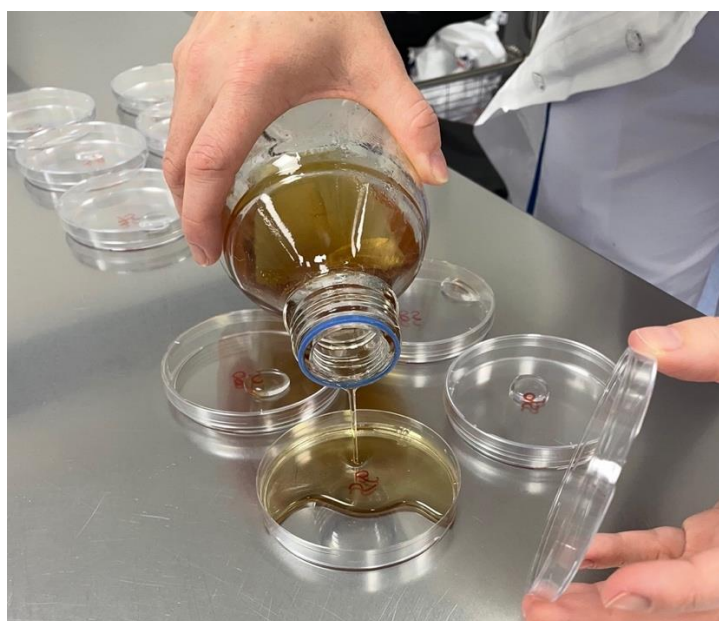
Obrázek 7: Zalévání vzorku agarem (Sabouradův agar)
