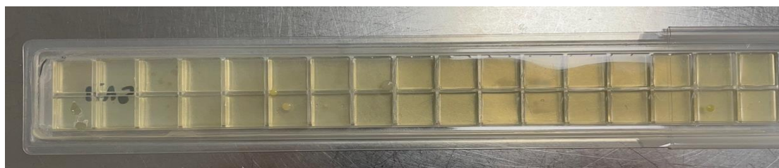
Obrázek 10: Strip TC pro stanovení celkového množství mikroorganismů ze vzduchu
