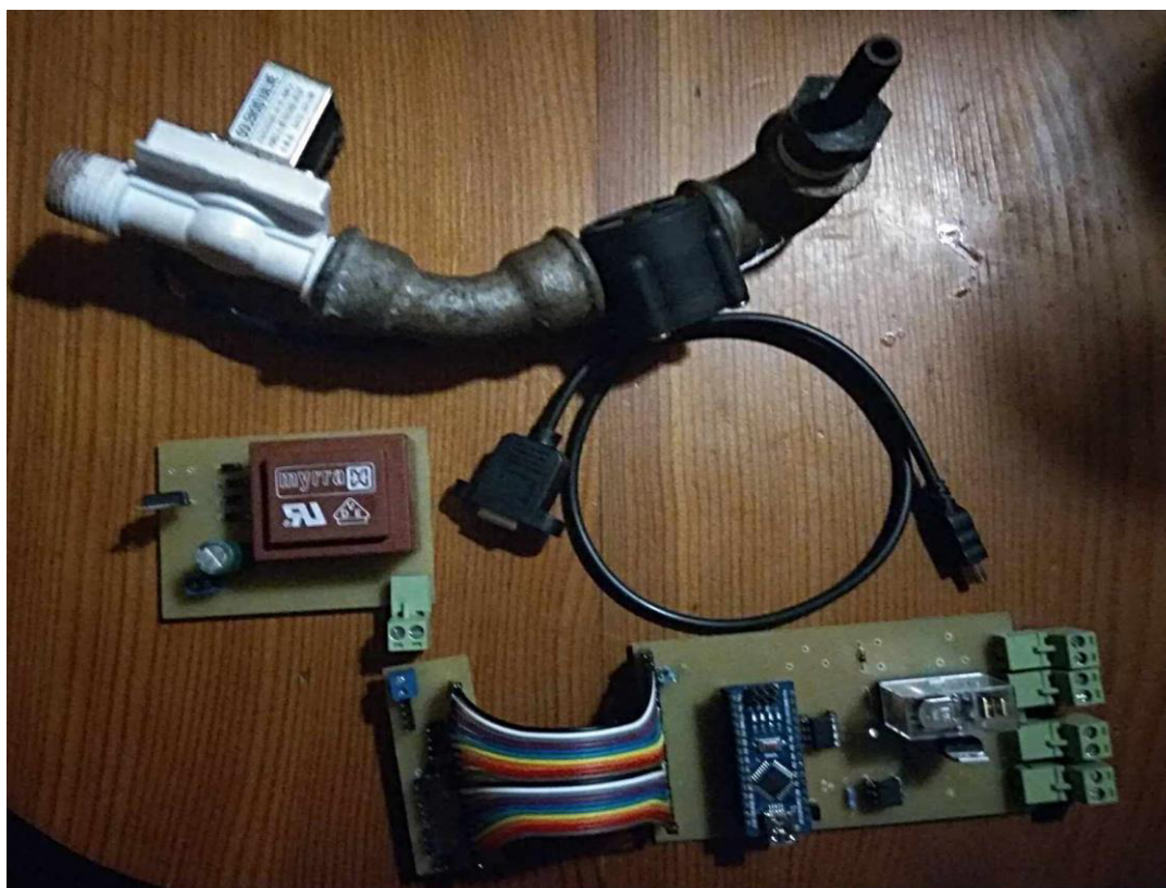
Obr. 4.19: Částečně osazené desky a další komponenty zařízení
