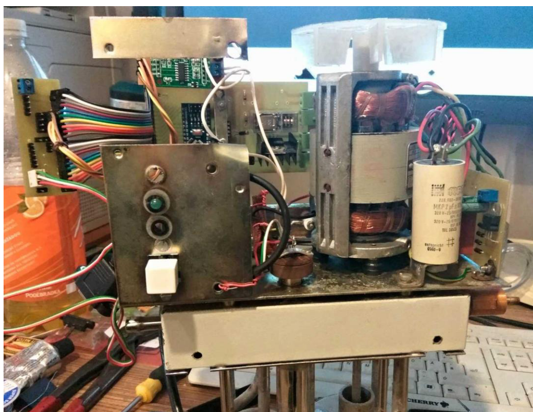
Obr. 4.20: Vnitřní uspořádání hlavy termostatu
