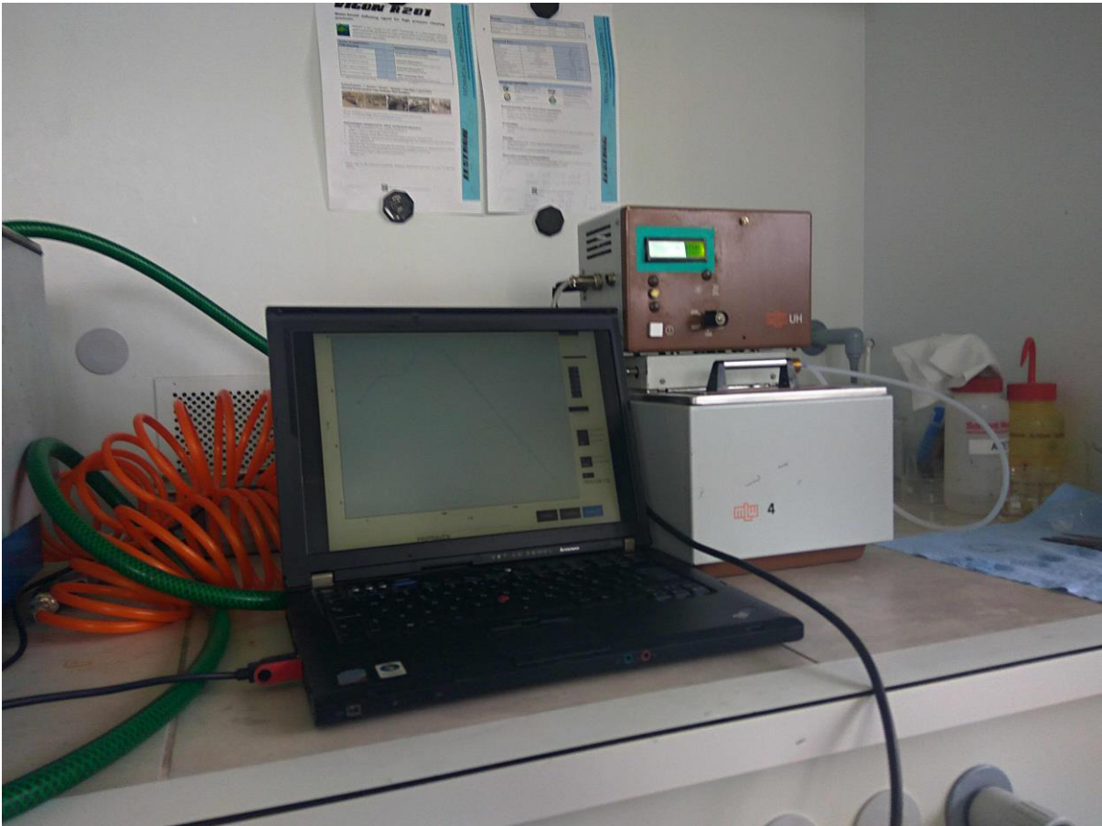
Obr. 4.21: Termostat v provozu s připojeným PC
