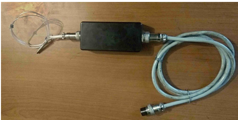
Obr. 4.12: Externí A/D převodník s připojeným snímačem Pt100
