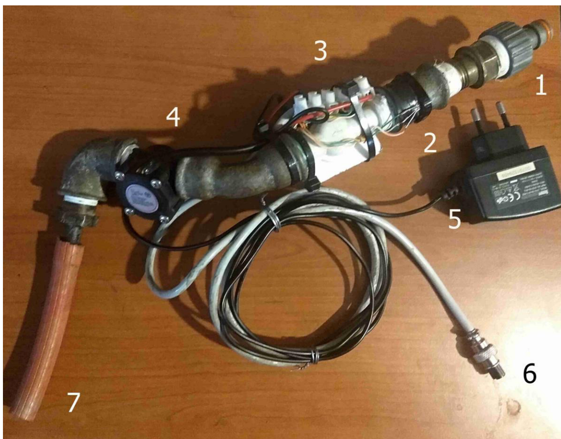
Obr. 4.18: Přípravek k externímu dochlazování
