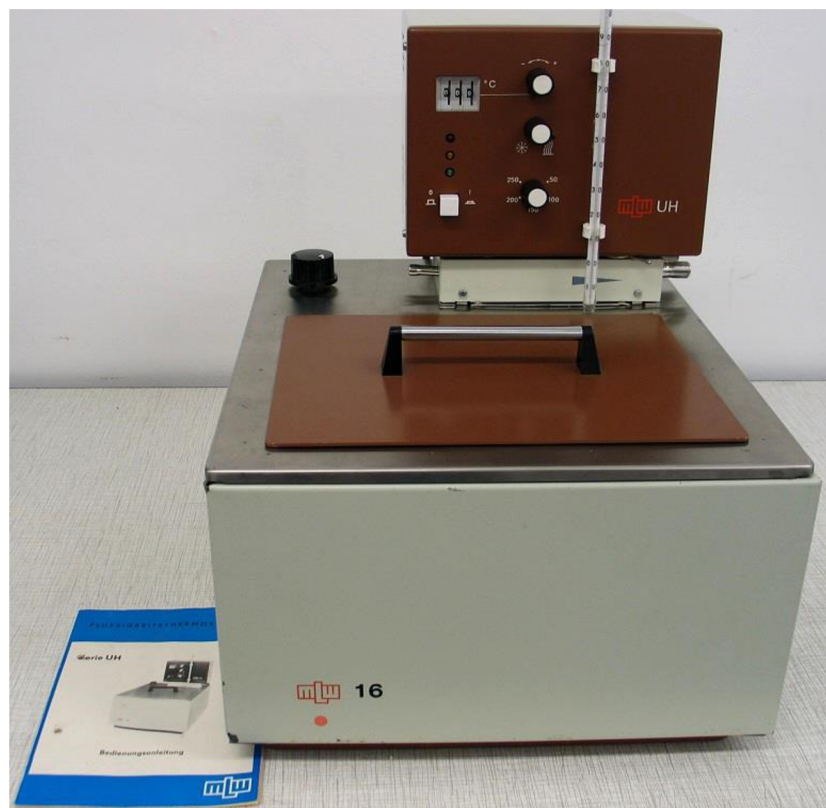
Obr. 4.1: Původní termostat MLW UH s nádobou o objemu 16 l [33]
