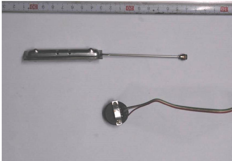
Obr. 4.15: Bezkontaktní plovákový spínač
