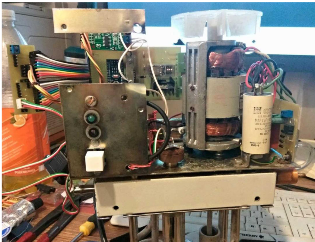
Obr. 4.20: Vnitřní uspořádání hlavy termostatu
