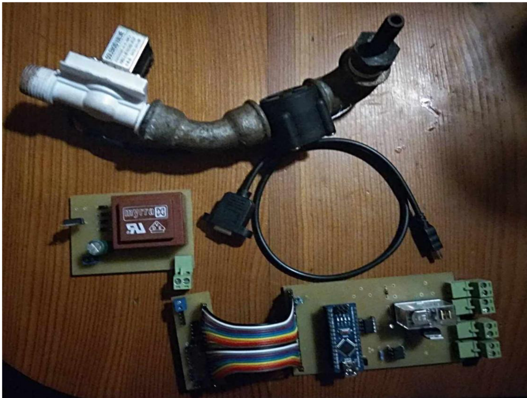
Obr. 4.19: Částečně osazené desky a další komponenty zařízení
