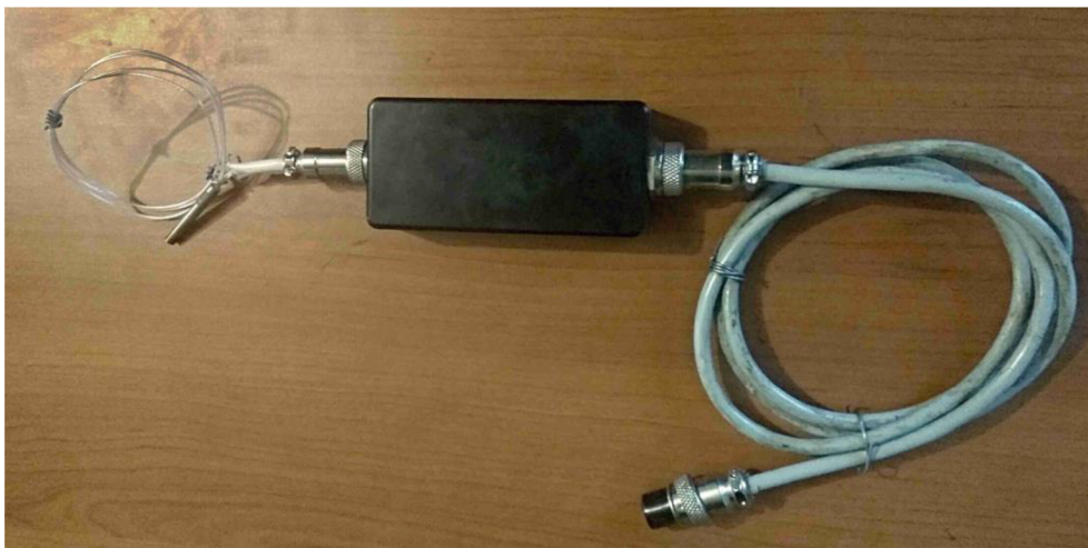
Obr. 4.12: Externí A/D převodník s připojeným snímačem Pt100
