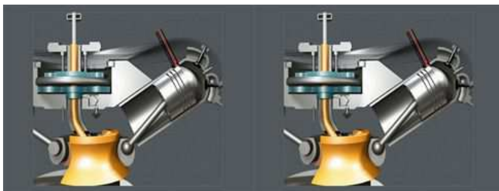
Obr. 4-3 Způsob změny kompresního poměru a objemu válce
