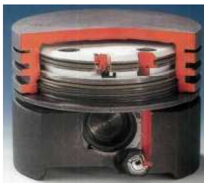
Obr. 3-15 Píst umožňující změnu komprese
