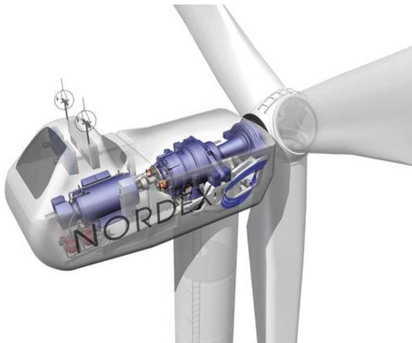
Obr. č. 4, Pohled do gondoly (Power technologi, 2010)
