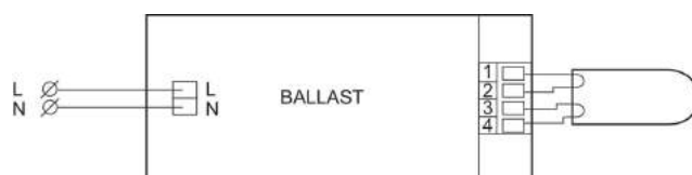
Obr. 3.6: Zapojení trubice k předřadníku [13]
